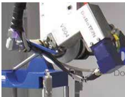
Bild 2: Proportional-Dosiersystem, zusätzlich an 4. Achse, zur 3D-Dosierung (Bild: DoBoTech AG)
