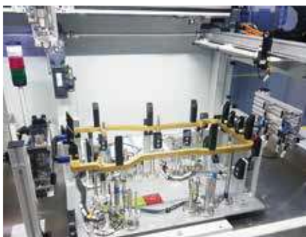
Bild 4: Handling-Tool, für Ergonomie und zum Schutz der Dichtraupe (Bild: DoBoTech AG)
