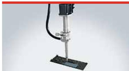
**Punktdosierung eines wärmeableitenden und isolierenden Klebstoffs** (Bild: ViscoTec Pumpen- u. Dosiertechnik GmbH)
