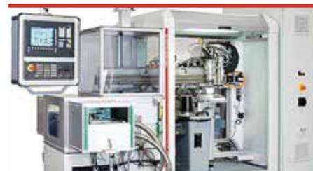
**Die Vakuumdosieranlage DC-VAC verfügt serienmäßig über eine Vakuummaterialaufbereitung und ist mit einem dynamischen Mischsystem ausgestattet** (Bild: RAMPF Production Systems GmbH & Co. KG)
