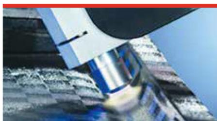
**Umweltschonende Vorbehandlung im Automobil-Leichtbau: Eine CFK-Oberfläche wird zur langzeitstabilen Haftung vor dem Verkleben mit Openair-Plasma feinstgereinigt und aktiviert** (Bild: Plasmatreat GmbH)
