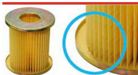
**Um langzeitbeständige Klebeverbindungen zu realisieren (hier: Luftfilter, verklebt mit Epoxidharz), müssen neben dem reinen Materialauftrag auch die vor- und nachgelagerten Prozesse sicher beherrscht und verstanden werden** (Bild: Scheugenpflug AG)
