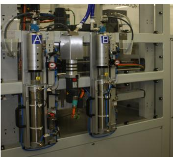
Kartuscheneinheiten & volumetrischer Antrieb Komponente A
