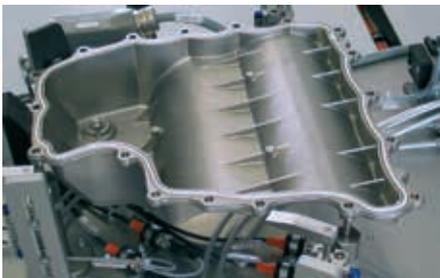
Durch ein einfach programmierbares CNC Dosiersystem können Änderungen im Konturverlauf schnell angepasst werden, aufwändiges Änderung von Formen, wie etwa bei vulkanisierten Dichtungen entfällt.
