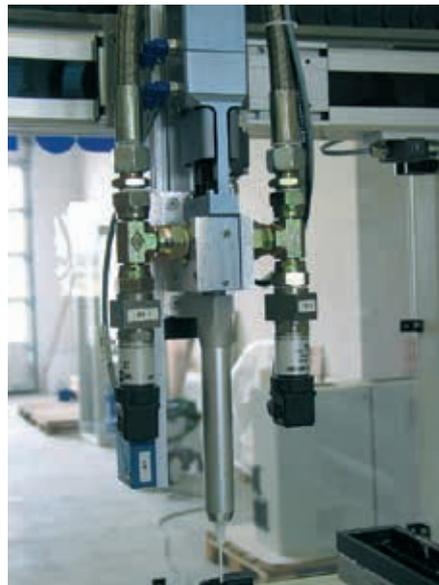
Zur Überprüfung des Mischungsverhältnisses sind zwei Volumenzähler in die Produktleitung für Komponente A und B integriert. Während des Produktauftrages wird die Menge beider Komponenten ständig kontrolliert und über die Pumpensteuerung nachreguliert.
