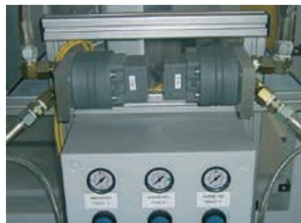
Die Produktförderung aus den 20 Liter Gebinden übernehmen zwei Schraubenspindelpumpen die über ein Planetengetriebe und Drehstrommotore angetrieben werden. Die Ansteuerung der Motore erfolgt über Frequenzumrichter die über die Visualisierung der CNC Steuerung parametrisiert werden können. Die Ansteuerung der Fassungspumpen Heber erfolgt pneumatisch.
