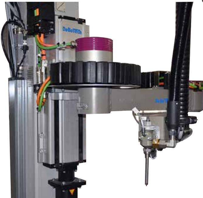
Scara-Kinematik mit Harmonic Drive NC-Antrieb
