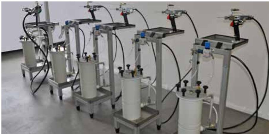
Das Handrotorspray für die Kolbenbohrung und Hubzapfen-Beölung ist mit separaten DQM Steuerkarten (Dosierkontrolle) und mit einer LED ausgestattet, die das Ende der Dosierzeit visualisiert.
