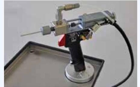
Die pneumatisch betätigten Dosierpistolen für die Lagerstellen-Beölungen arbeiten mit Volumenkammer-Dosierventilen. Die voreingestellte Ölmenge wird durch einmalige Betätigung dosiert. Damit die Bauteile nicht beschädigt werden, sind die Dosierkanülen mit einer Kunststoffkappe versehen.
