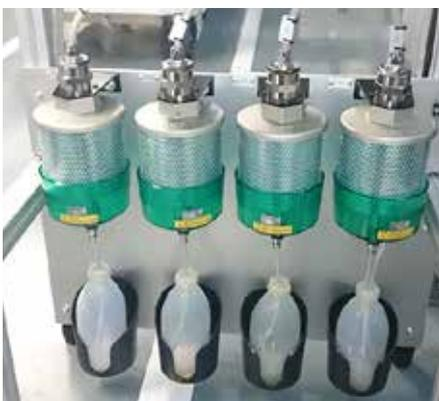
Filter der Ölabsaugung mit Restölflaschen
