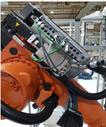
Zahnradpumpe am Roboterarm
